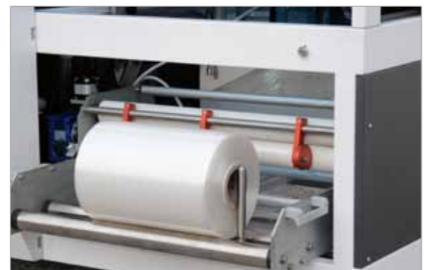
Unità svolgibobina facile da raggiungere Film dispenser unit in front of the machine easy to be reached
