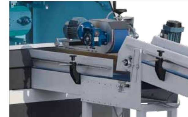
Caricamento e raggruppamento automatico degli astucci facciali Automatic facial tissue boxes collation
